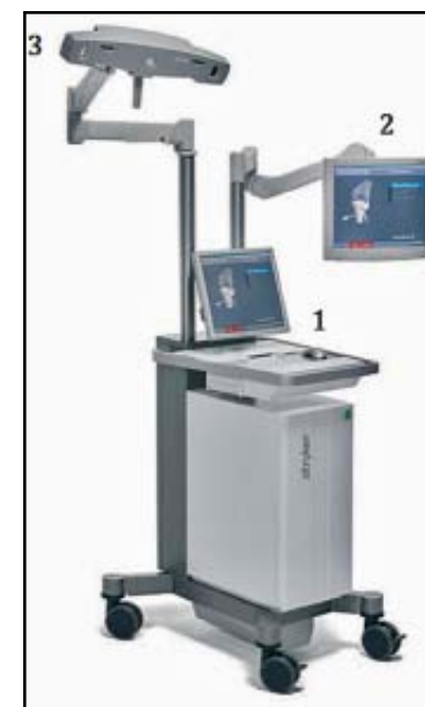
Figura 1. Navegador con sistema de comunicación óptico. Se observan sus diferentes componentes: 1. Estación computacional. 2. Monitor para el cirujano. 3. Sistema de comunicación óptico.
