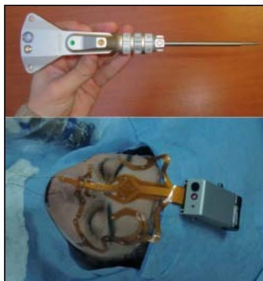
Figura 2. En la imagen superior se observa el puntero utilizado para realizar el rastreo intraoperatorio. En la imagen inferior se observa la máscara de silicona que permite realizar el registro de los puntos anatómicos.
